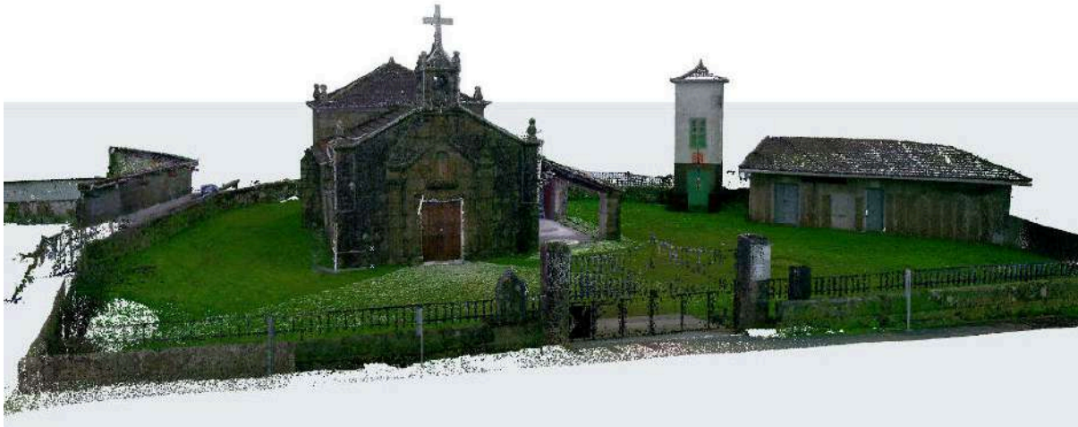
Fig. 2. Visualización y exploración de la nube de puntos global en el proyecto HBIM de ArchiCAD.
