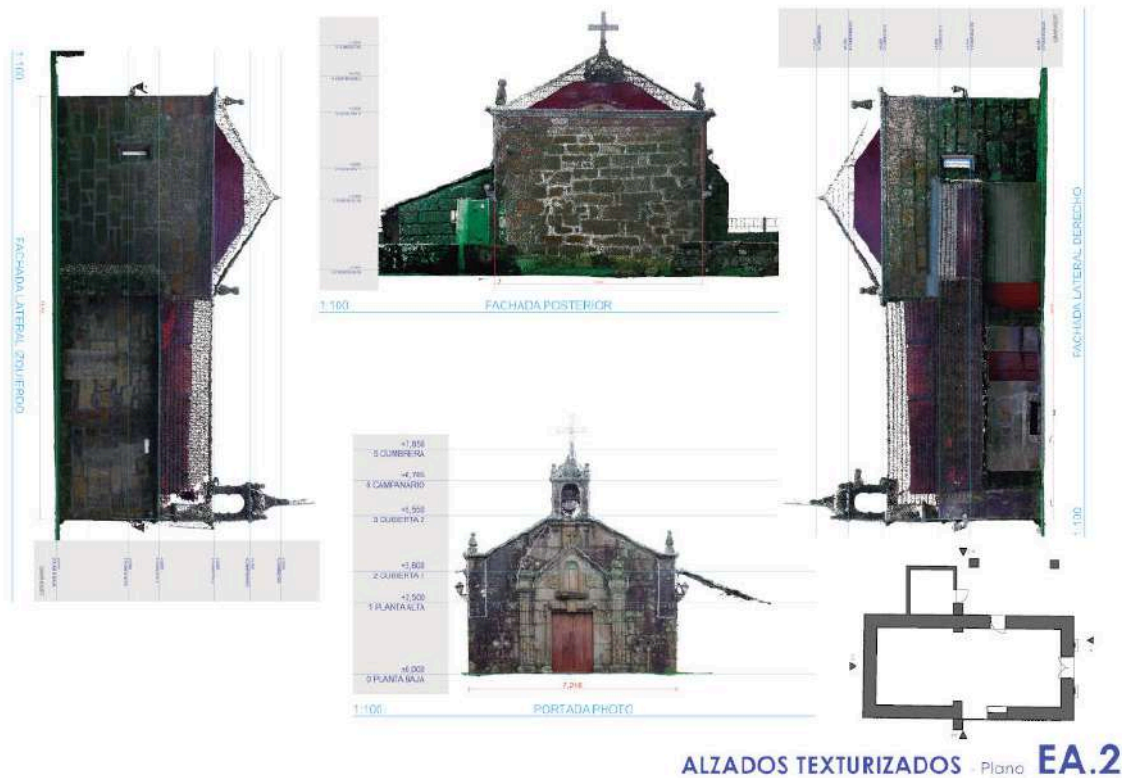
Fig. 3. Plano con los Alzados texturizados generado en ArchiCAD Graphisoft. Fuente: Enrique Nieto
